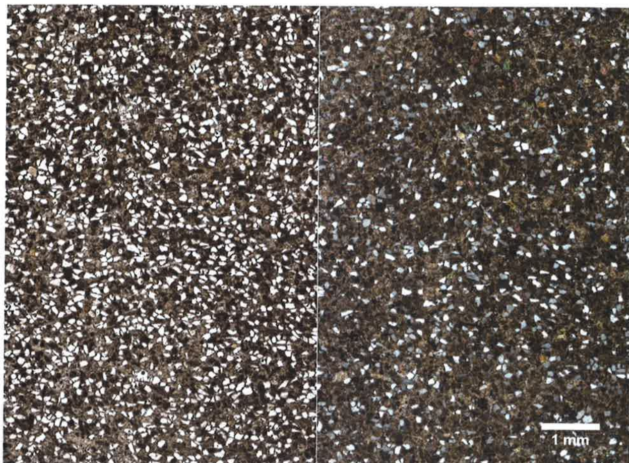
Figure 2. – Microphotographies de la lame mince 128705 en lumière transmise non polarisée (à gauche) et polarisée (à droite). La roche est constituée de grains de quartz, qui apparaissent clairs dans le cliché de gauche et dans les nuances de gris dans le cliché de droite. Le reste de la roche est cimenté par du carbonate de calcium (calcite, en sombre à gauche et brunâtre à droite).
